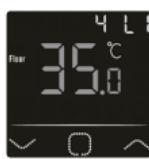
Предустановленная заводская настройка для обогрева поверхностей с высокой теплопроводностью: керамическая плитка, керамогранит, мрамор и т.п. + 35°C.
