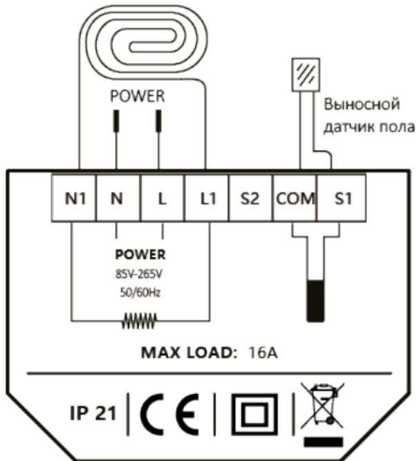
Для управления системой электрообогрева «теплый пол», подсоедините к клеммам СОМ и S1 выносной датчик пола NTC 10K, входящий в комплект поставки.
